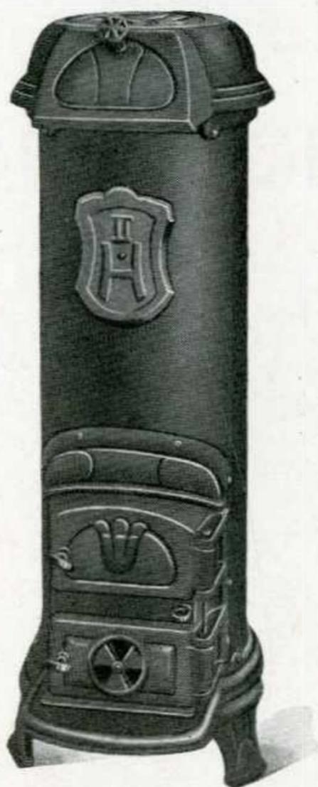
Ces calorifères sont formés d'un corps cylindrique en tôle, garni intérieurement de briques réfractaires, d'un chapiteau et d'un socle en fonte noire. Ils sont étudiés pour pouvoir brûler tout combustible : anthracite, coke, charbon ou bois.
